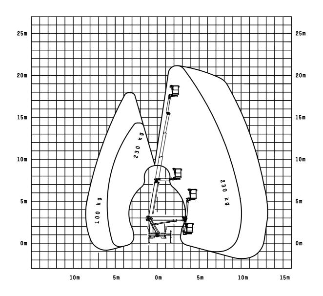
Fahrzeuggesamtmasse Nissan 3,5 t 16.05.2013 / Fi Die Reichweiten sind ca.-Ma $\beta$ e und sind abhängig vom Fahrgestell. Art der Abstützung und Zusatzausrüstung der Hubarbeitsbühne. Darstellung vom LKW und Gerät haben nur Symbolcharakter und lassen keine Rückschlüsse auf die techn. Ausführung zu.
