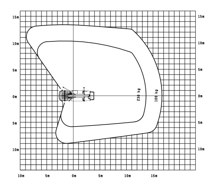
Fahrzeuggesamtmasse Nissan 3.5 t 24.05.2013 / Fi Die Reichweiten sind ca.-Ma $\beta$ e und sind abhängig vom Fahrgestell. Art der Abstützung und Zusatzausrüstung der Hubarbeitsbühne. Darstellung vom LKW und Gerät haben nur Symbolcharakter und lassen keine Rückschlüsse auf die techn. Ausführung zu.
