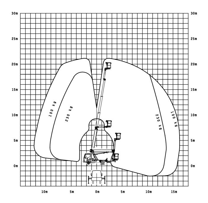
Fahrzeuggesamtmasse Nissan 3.5 t 23.05.2013 / Fi Die Reichweiten sind ca.-Ma $\beta$ e und sind abhängig vom Fahrgestell, Art der Abstützung und Zusatzausrüstung der Hubarbeitsbühne. Darstellung vom LKW und Gerät haben nur Symbolcharakter und lassen keine Rückschlüsse auf
